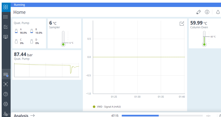
図 3. Agilent InfinityLab Assist のホーム画面。下の分析コントロールパネルに分析中であることが表示されています。
