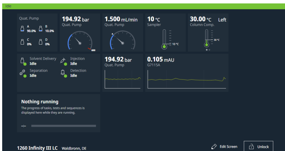
図 2. アンビエント画面。カスタマイズ可能なウィジェットにステータス情報が表示されています。
