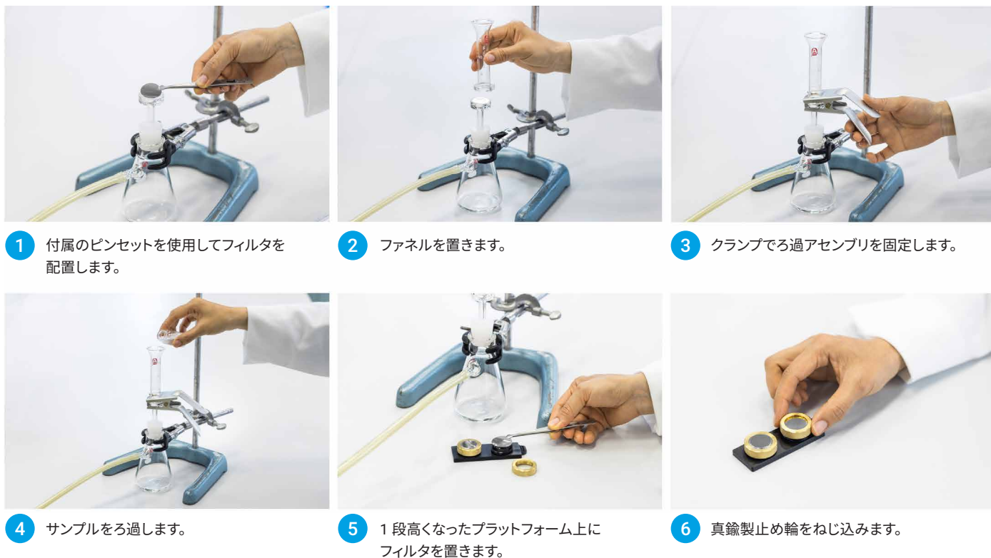
図 5. アルミニウムコートフィルタ上にマイクロプラスチックサンプルをろ過する装置と手順。Agilent 8700 LDIR ケミカルイメージングシステムによる分析の準備を整えるために使用
