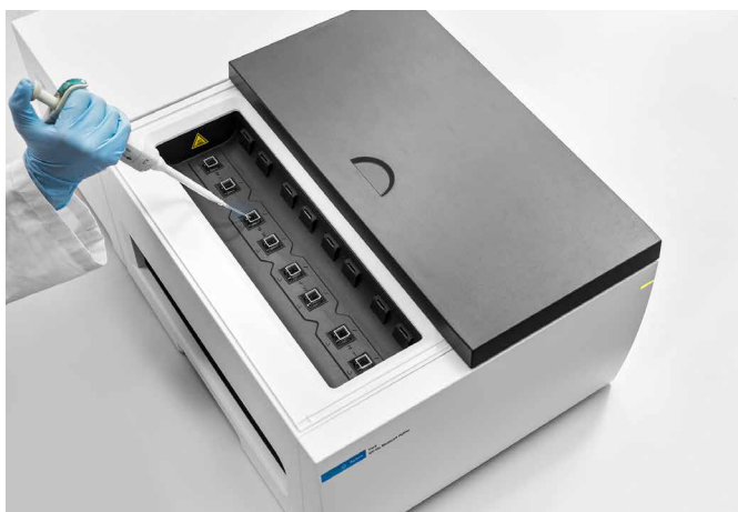
図 1. Agilent Cary 3500 UV-Vis マルチセル分光光度計は、8 つのキュベット位置において、最大 4 つの温度実験で同時に使用できます。
