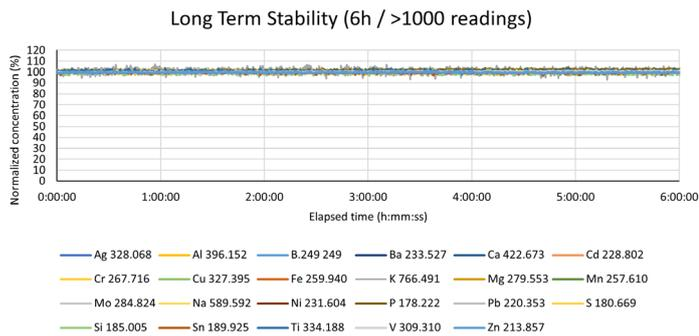
AVS7 と、半揮発性物質アプリケーション用のフルデマンタブルトーチおよびアルミナ製（耐フッ酸）1.4 mm インジェクタを搭載した Agilent 5900 SVDV ICP-OES を使用し、Caterpillar ホイールローダーから取得した、使用済み潤滑剤サンプルを測定しました。内部標準として Y を使用した、6 時間以上にわたる使用済み油サンプルの 1,000 回以上の連続分析の結果から、その堅牢性が実証されました。
