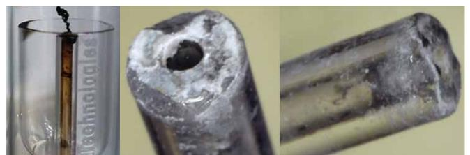
同じアプリケーションでアルミナインジェクタを使用した場合も、インジェクタの炭素蓄積は発生します（下の写真）。プロトーチを使用して炭素を燃焼させた後に、インジェクタの先端に一部の無機残留物が残ります（中央）。これは、希酸に浸すことで簡単に除去でき、インジェクタがきれいになります（右）。写真のアルミナインジェクタには、石英インジェクタと同じように 5 回の洗浄サイクルを実行しました。劣化は生じず、性能や分析時間に影響はありませんでした。
