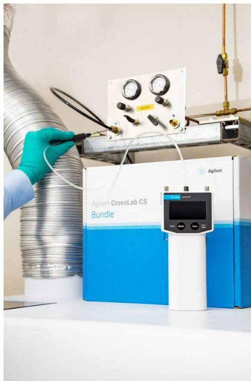
図 10. Agilent CrossLab CS リークディテクタを使用したアルゴンガスフィッティングのチェックの例
