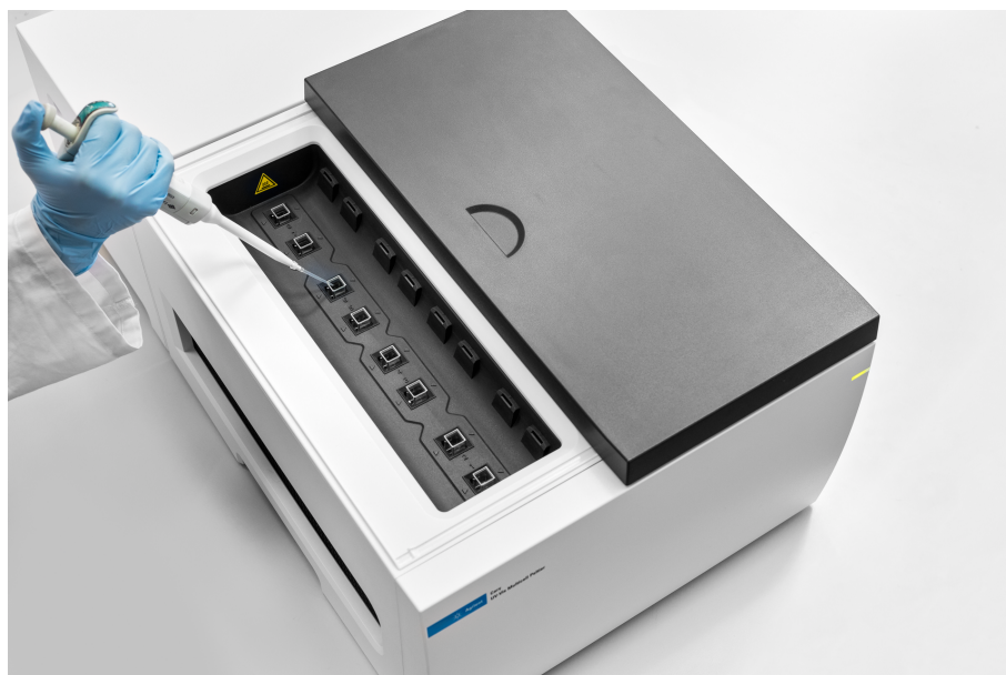
図 2. マルチセルベルチェサンプリングモジュールを組み合わせた Agilent Cary 3500 UV-Vis 分光光度計は、8 つのキュベット位置において、最大 4 つの温度実験で同時に使用できます。
