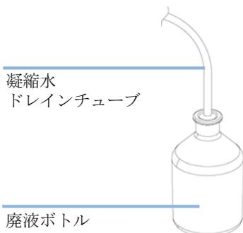
図 6 凝縮水ドレイン出口
