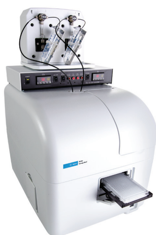
Synergy Neo2 と CO 2 /O 2 ガスコントローラーおよび デュアル試薬インジェクター
