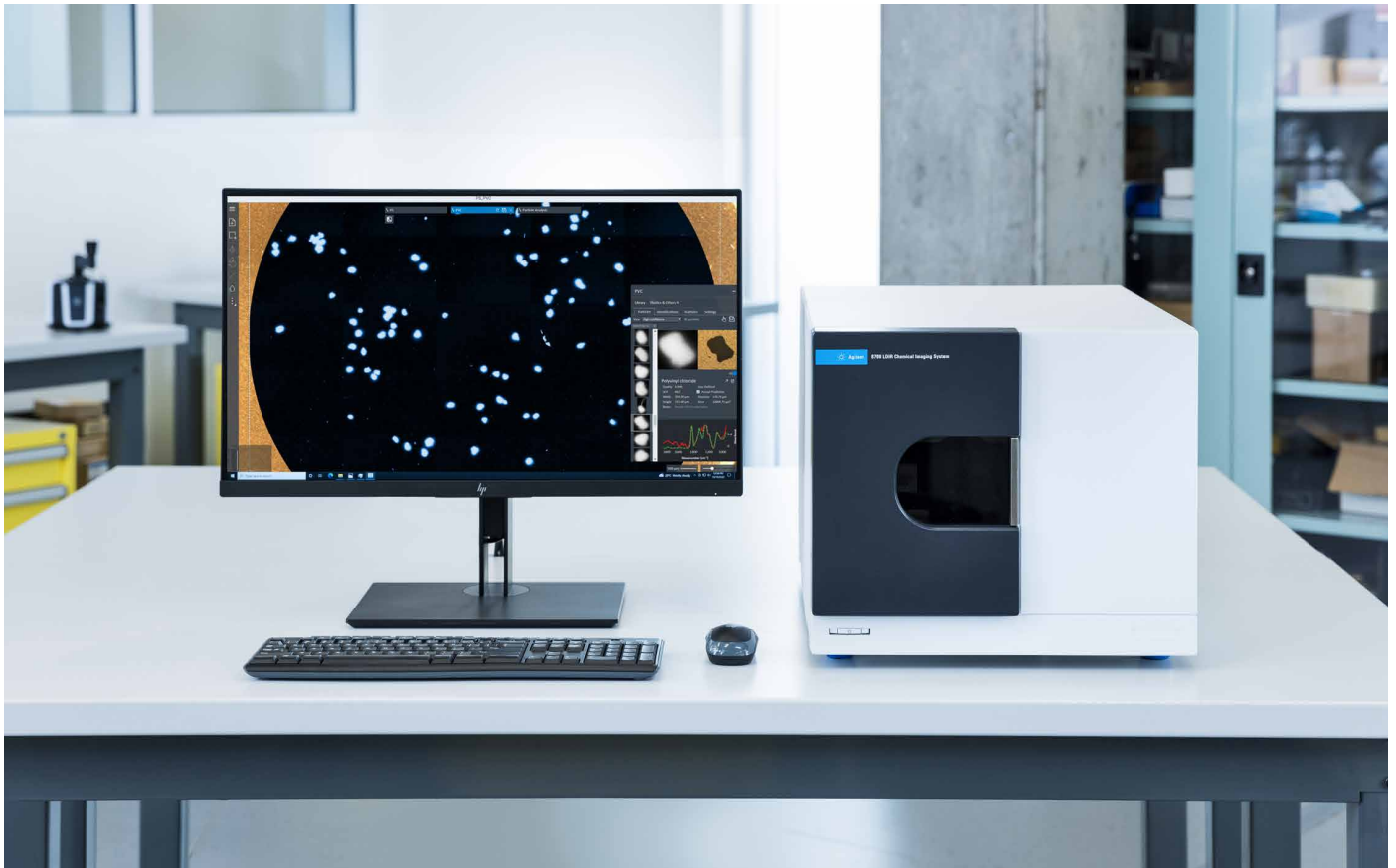
図 2. Agilent 8700 LDIR ケミカルイメージングシステム。サンプルに含まれる粒子の数、サイズ、化学組成など、マイクロプラスチックのルーチン分析を高速で実行できます。
