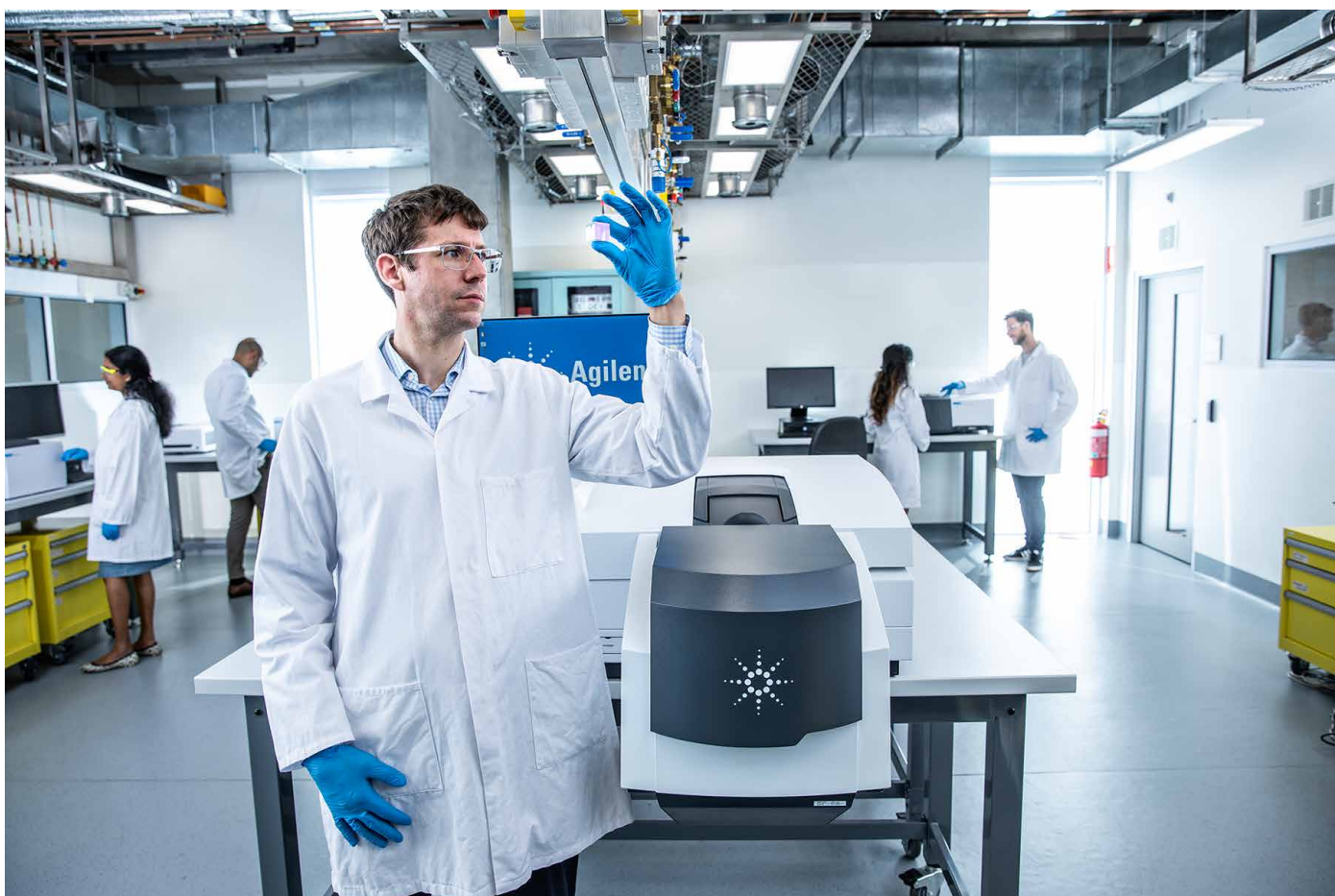
図 1. Agilent Cary 7000 多角度可変自動測定分光光度計 (UMS)。キューブビームスプリッタなど多様な光学サンプルの完全な特性解析が可能です。
