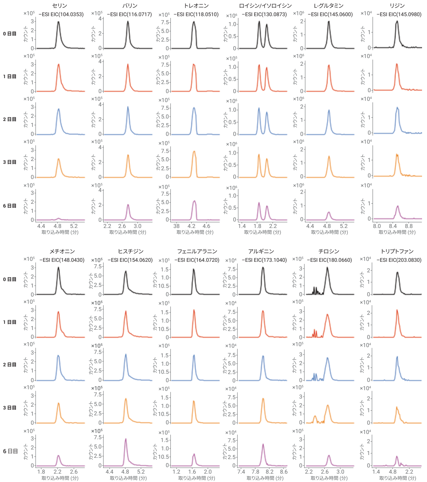
図 4. 細胞培地中におけるアミノ酸栄養素の消費のモニタリング
