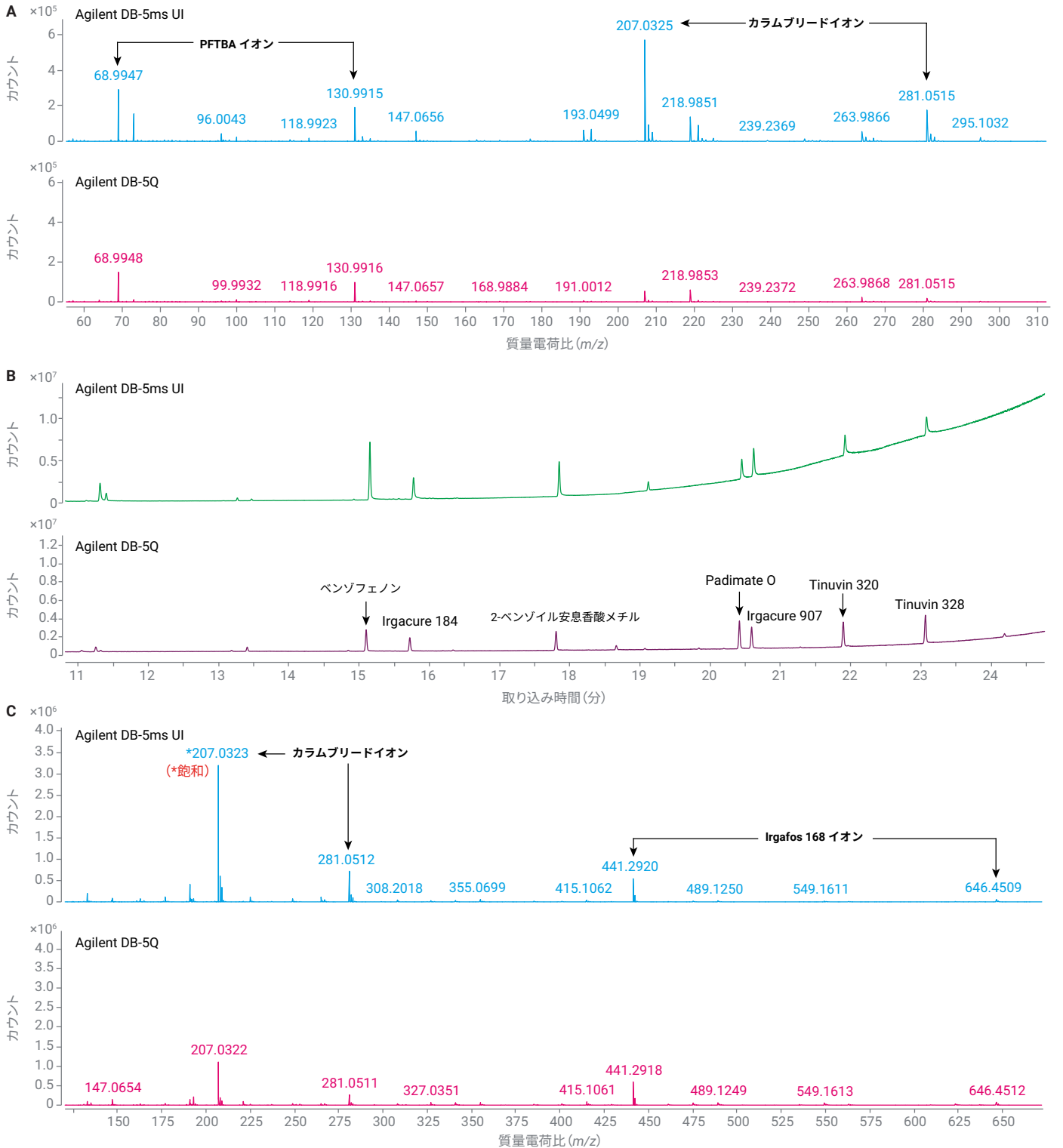
図 2. GC/Q-TOF での Agilent DB-5ms UI および DB-5Q カラムブリードの比較。(A) オープン温度 325 °C、イオン化電流 0.3 \mu A で採取したバックグラウンドおよび PFTBA スペクトル。(B) UV 吸収剤の TIC。(C) バックグラウンド除去なしの酸化防止剤 Irgafos 168 の生スペクトル (RI が 3,398、RT が 27.6 分の高沸点化合物)
