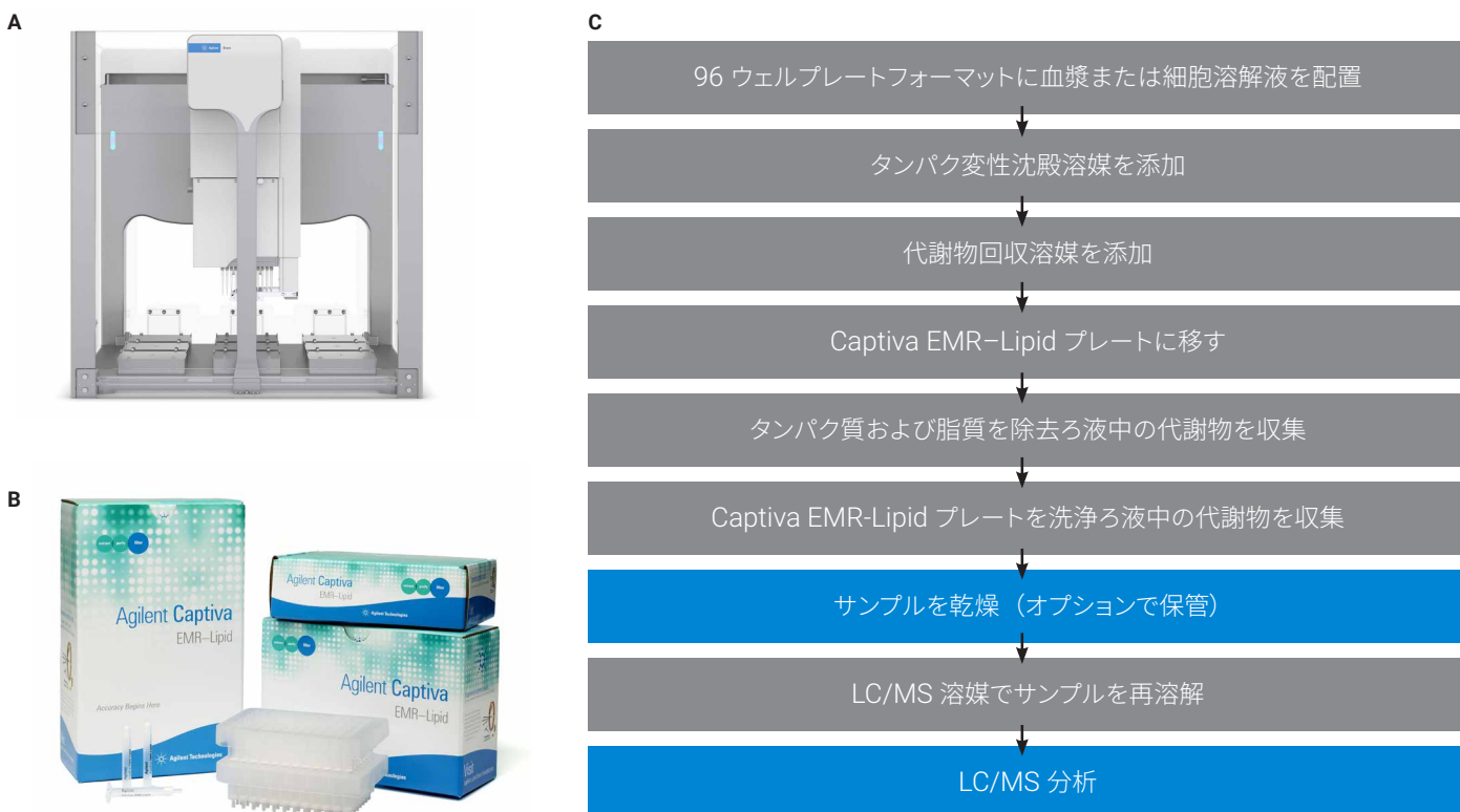
図 2 : ターゲットメタボロミクス研究の自動サンプル前処理用のアジレントソリューション。 A. Bravo Metabolomics Sample Prep Platform B. Captiva EMR-Lipid 固相抽出プレート C. 一般的な極性代謝物抽出プロトコル
