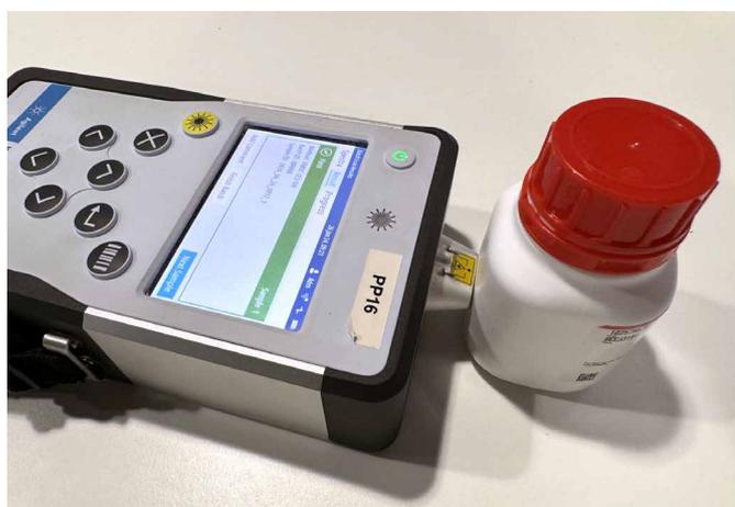
図 1. Fmoc 保護アミノ酸の検証に使用されている Agilent Vaya ラマン原料同定検証システム
