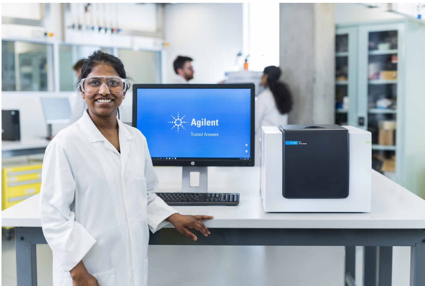
図 1. Agilent Cary 3500 フレキシブル UV-Vis 分光光度計は、大型サンプルコンパートメントを備えており、複数のアクセサリを取り付けることができるため、固体サンプルの特性解析に最適です。
