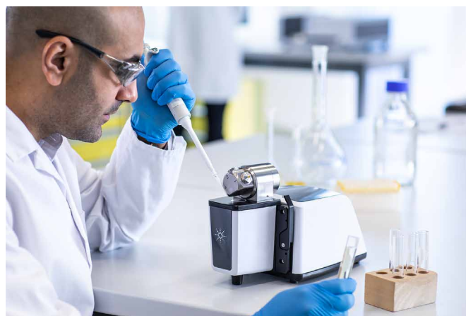
図 2. 液体サンプルは、Agilent Cary 630 FTIR 分光光度計に装着された Agilent DialPath アタッチメントのサンプルウィンドウに配置します。
