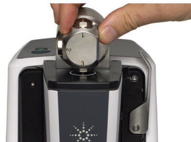
3 Agilent DialPath を目的の光路長にセットして測定します。
