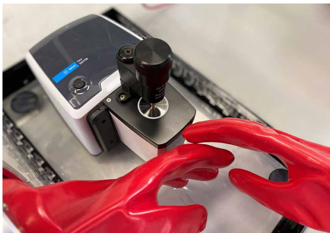
図 1. 超コンパクトで軽量な設計 (20 × 20 cm、3.6 kg) の Agilent Cary 630 FTIR 分光光度計は、グローブボックス内で簡単に使用でき、水分の影響を受けやすい化学物質や危険な化学物質に対して、高品質の結果を生成します。
