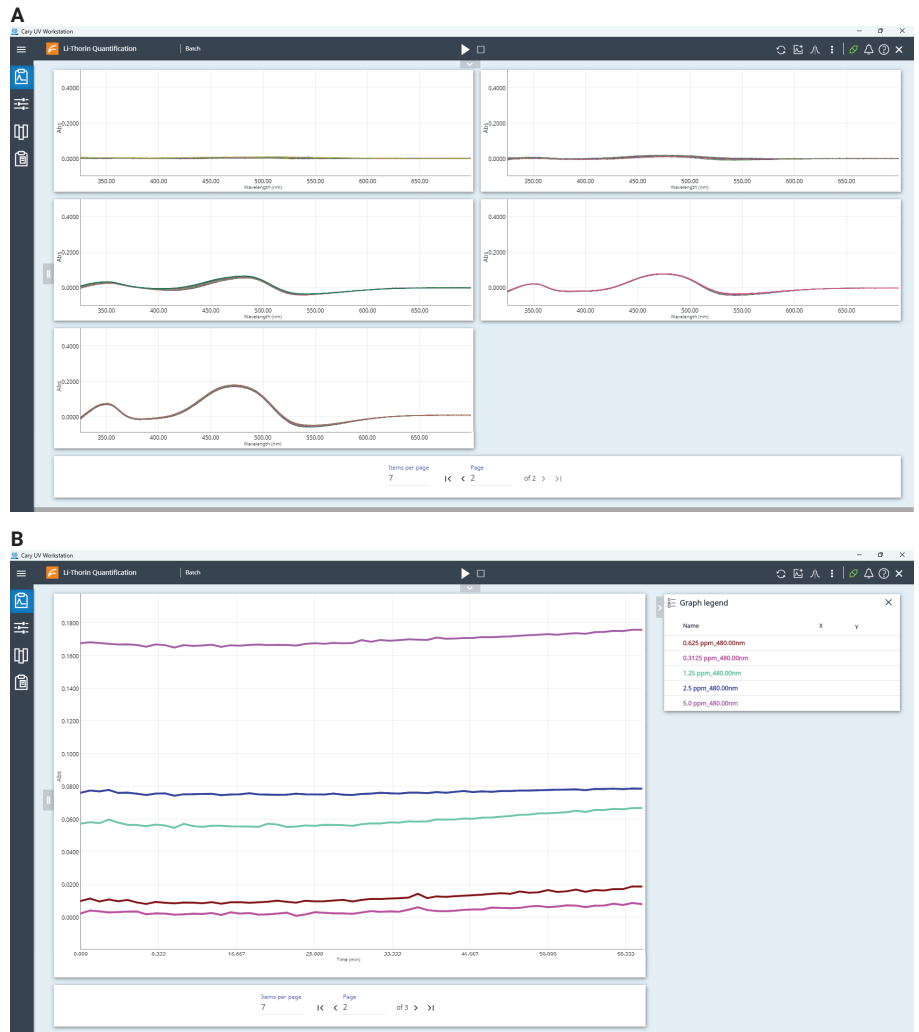
図 6. 5 つの LiCl 標準液 (アセトニトリルで調製、0.2 % トリン) の動態を 60 分にわたりモニタリングしました。(A) 波長範囲スキャン、および (B) 480 nm 単一波長スキャン。Agilent Cary 3500 マルチセル UV-Vis により、最大 7 つのサンプルを同時にモニタリングすることが可能です。
