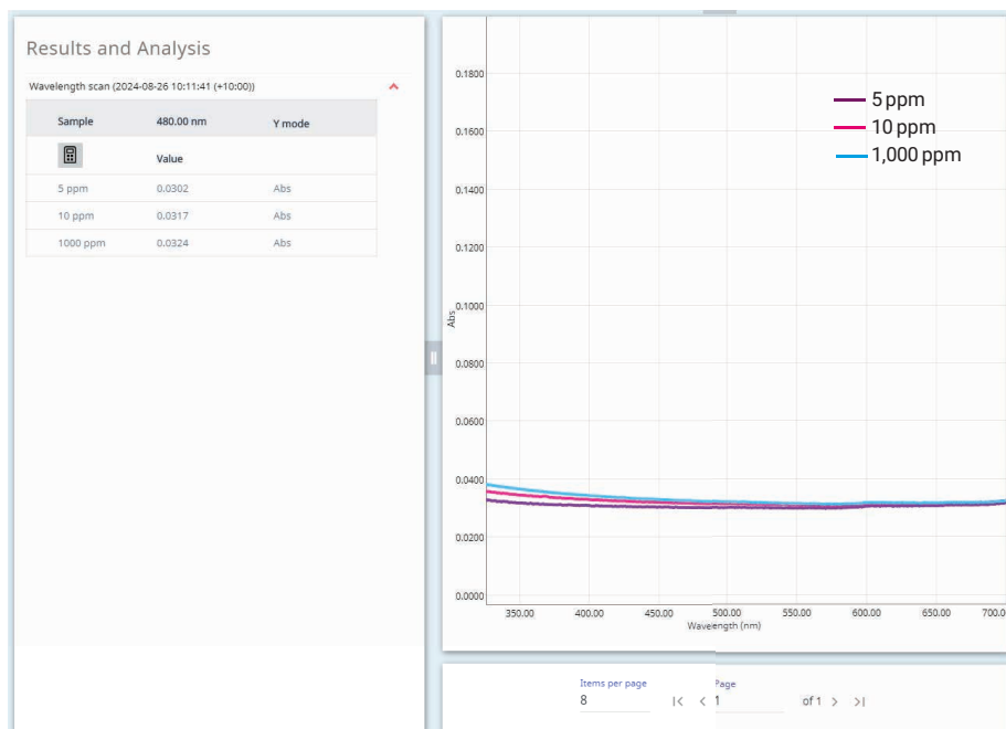
図 2. Agilent Cary 3500 マルチセル UV-Vis 分光光度計を使用して測定された、水中の LiCl 溶液（5、10、1,000 ppm）の UV-Vis スペクトル。サンプルは空気に対してベースライン補正しました。
