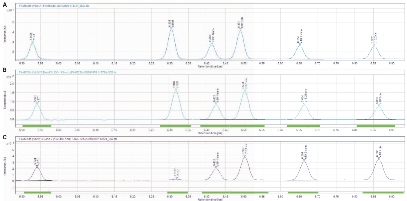
図4. FID (A) と LUMA のバンド 2 (B) および 7 (C) で分析した、FAME 混合標準液中の c17:1 ~ c18:3n6 のクロマトグラム拡大図
