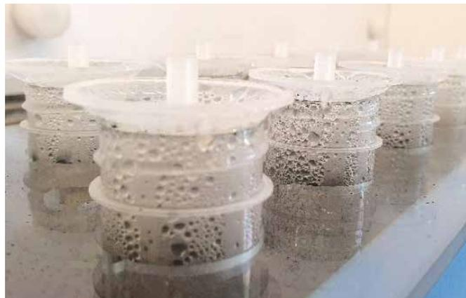
図 2. HotBlock 分解装置内の BM サンプル
