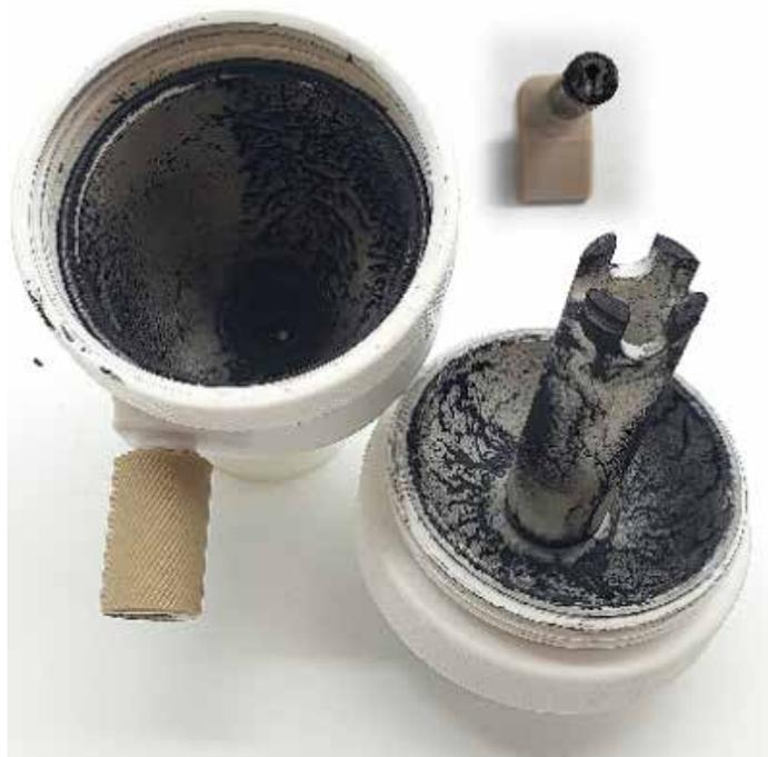
図 5. 測定終了時のスプレーチャンバと Agilent 不活性 V-groove ネブライザ
